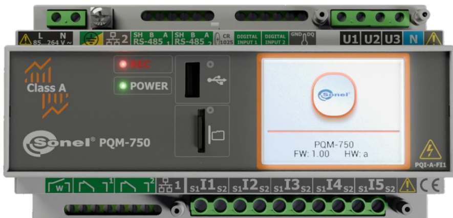
Rys. 1. Analizator jakości zasilania PQM-750. Widok ogólny.
